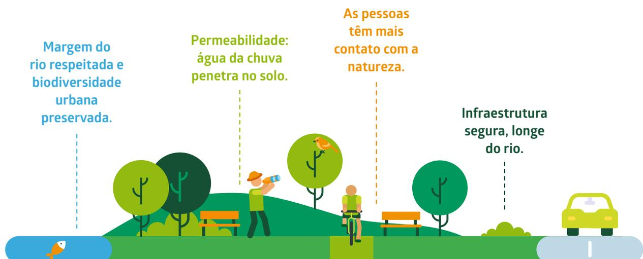
Os parques lineares são áreas naturais protegidas localizadas às margens de rios, que protegem a infraestrutura urbana, evitando inundações e enchentes. A permeabilidade do solo reduz a velocidade de escoamento superficial da água, permitindo que a água da chuva possa se infiltrar no solo.
